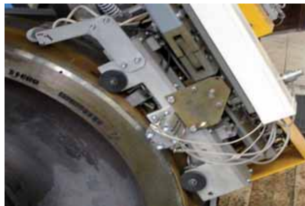
Рис. 7 - Ультразвуковой модуль контроля колеса КП
