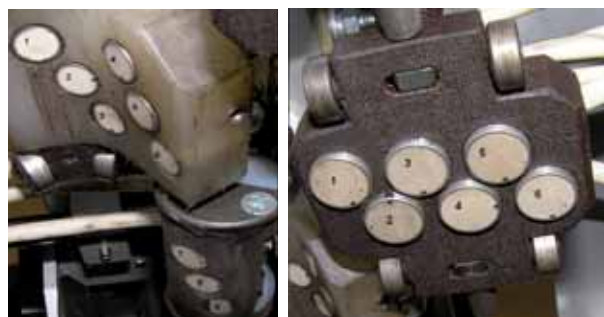
Рис. 10 - Модуль ВТК обода ж/д колеса
