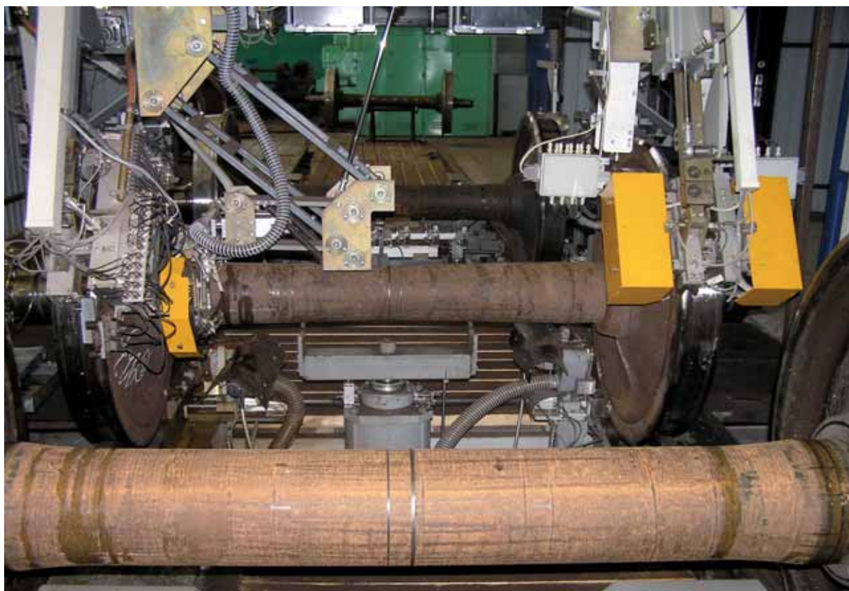
Рис. 2 - Общий вид установки СНК КП-8
