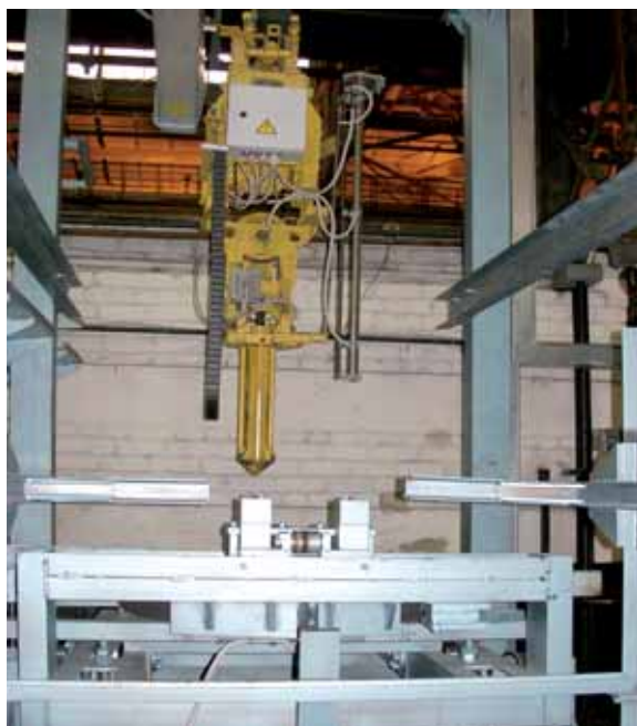
Рис. 9 - Манипулятор объединения постов выгрузки
