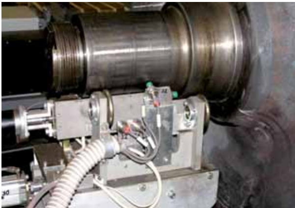
Рис. 14 - Вихретоковый сканер шеек и предподступичной части оси
