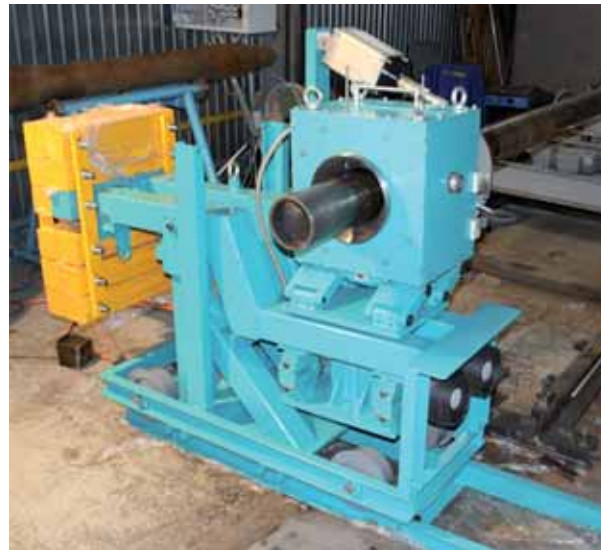
Рис. 3 - Внешний вид блока проходного ВТП
