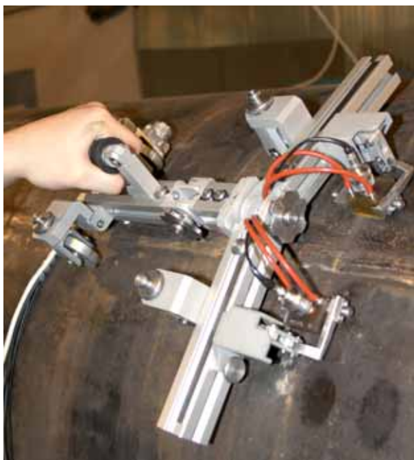
Рис. 5 - Сканер "СК-TOFD Pro" для контроля протяженных сварных швов
