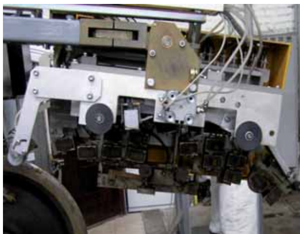
Рис. 6 - Сканер обода колеса ультразвуковой
