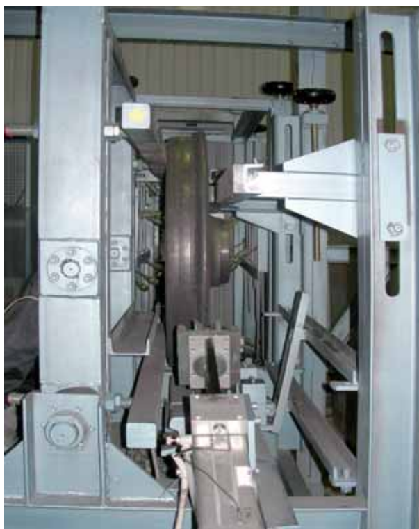
Рис. 2 - Пост загрузки УМПК-2
