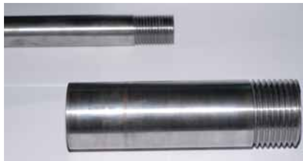
Рис. 4 - Стандартные образцы предприятия (СОП) для контроля конической резьбы
