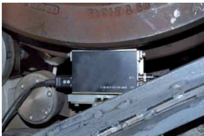
Рис. 13 - ЭМА сканер поверхности катания колеса
