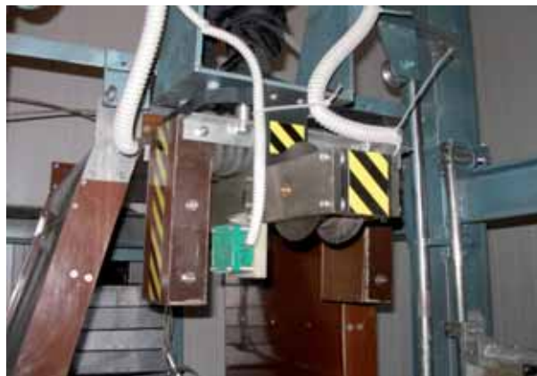
Рис. 10 - Система намагничивания колеса УМПК-2
