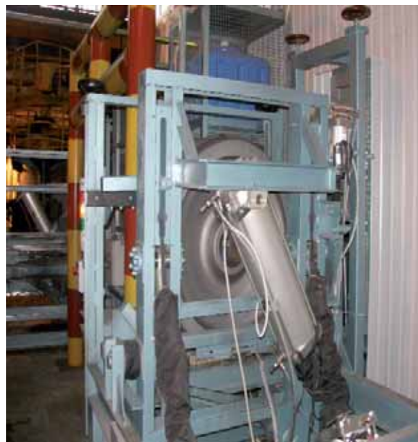
Рис. 5 - Пост загрузки колеса УМПК-2
