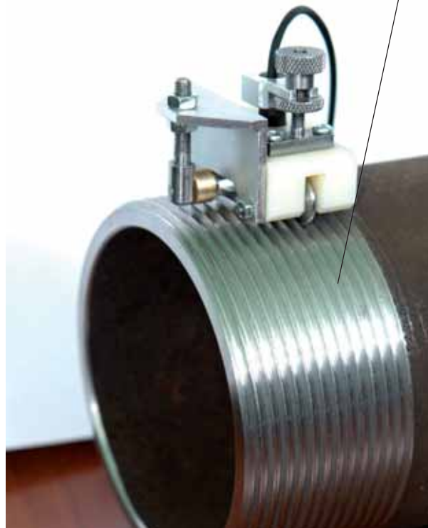
Рис. 5 - Сканирующие устройства для контроля наружной конической резьбы буровых труб:
