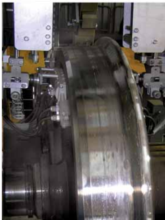
Рис. 11 - Модуль ВТК зон перехода диска в обод ж/д колеса
