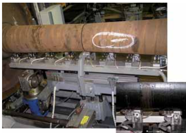
Рис. 12 - Модуль ВТК средней части оси
