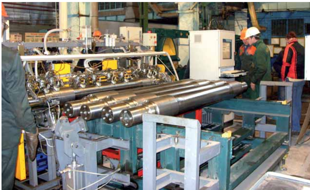
Рис.1 - Установка автоматизированного комплексного контроля железнодорожных осей колесных пар вагонов "СНК "Ось-3"
