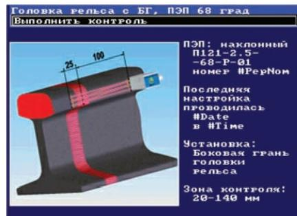
Этот режим используется для решения специализированных задач. Например, при контроле различных однотипных деталей или в случае, когда деталь имеет много зон контроля. Для решения этой задачи в УДЗ-71 используется система "Спец Меню". Необходимые типовые настройки и программный интерфейс "СпецМеню" заносятся в дефектоскоп с ПЭВМ. Введенные настройки нельзя испортить (изменить) дефектоскописту (оператору).
