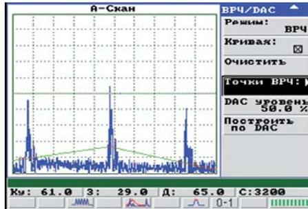
Уровень ВРЧ устанавливается в сетке точек, соединенных линейными участками, т.о. можно задать различные формы кривой ВРЧ - кусочно-линейную, ступенчатую и т.д. Уровень ВРЧ соответствует ослаблению сигнала в данной точке относительно установленного значения коэффициента усиления. Эта опция позволяет контролировать длинномерные изделия и изделия из материалов с большим затуханием, используется для настройки чувствительности при контроле сварных соединений с толщиной стенки более 12 мм.
