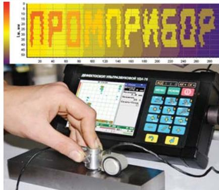
Для проведения толщинометрии, а также дефектоскопии околошовных зон сварных соединений разработаны специальные режимы, позволяющие при помощи каретки, в которой закреплен ПЭП проводить дефектоскопию и толщинометрию контролируемой зоны с фиксацией координаты пути сканирования при помощи датчика перемещений и дальнейшей обработкой полученных данных, в результате которой можно получить профиль поверхности, содержащий все возможные несоответствия по толщине металла, расслоения и язвенные поражения.
