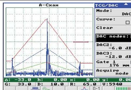
Режим ДАС является альтернативой режиму ВРЧ и предоставляет возможность построения кривой, соединяющей точки на экране, соответствующие вершинам сигналов, а также построения до двух дополнительных кривых, отстоящих от базовой на указанное количество дБ. Режим ДАС также предоставляет возможность быстрого и удобного построения кривой ВРЧ.
