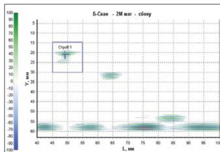
**Абс1:** L = 49.43 мм, Y = 20.92 мм, A = 27.95 дБ, Δ = 4.01 дБ, dL = 9.00 мм, dY = 6.65 мм
