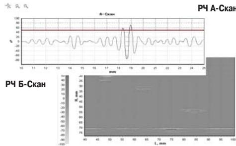
Для высокоточного измерения толщины изделия и координат дефектов используется недетектированный РЧ (радиочастотный) сигнал, что позволяет обеспечить дискретность измерения 0,01 мм. В приборе предусмотрены два режима выбора точки на кривой сигнала, по которой проводятся измерения (автоматический и ручной).
