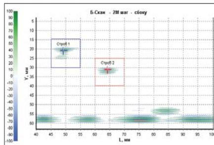
**Абс1:** L=49.43 мм, Y=20.92 мм, A=27.95 дБ, Δ=4.01 дБ, dL=9.00 мм, dY=6.65 мм
