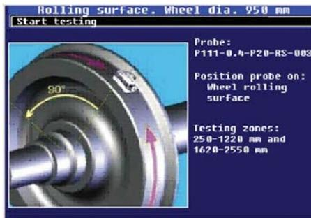
Этот режим используется для решения специализированных задач. Например, при контроле различных однотипных деталей или в случае, когда деталь имеет много зон контроля. Для решения этой задачи в УД4-76 используется система "Спец Меню". Необходимые типовые настройки и программный интерфейс "СпецМеню" заносятся в дефектоскоп с ПЭВМ. Введенные настройки защищены от некорректного изменения дефектоскопистом.
