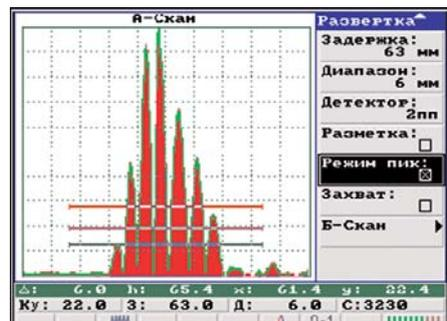
контакта. При этом на экране одновременно с максимальной огибающей всех наблюдаемых эхо-сигналов (отображается красным цветом) индицируется текущее значение сигнала. Этот режим используется для нахождения максимальной амплитуды эхо-сигнала и оценки условной протяженности. Может быть использован для документирования результатов контроля как для бракованных, так и для годных изделий, чем будет подтверждаться наличие или отсутствие дефектов по всему периметру сканирования.
