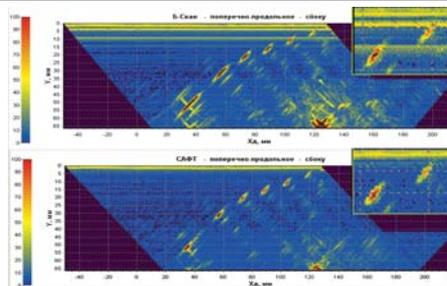
Для получения более качественных данных и результатов контроля разработано специальное программное приложение реализующее алгоритм SAFT для использования в дефектоскопии сварных соединений и заготовок из сталей. Этот алгоритм позволяет при обработке данных получить более высокое значение отношения "сигнал/шум" (в том числе при контроле объектов из крупнозернистых материалов) и передать приблизительную форму дефекта.
